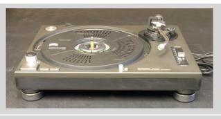
DISCONNECT THE DECK FROM THE MAINS BY PULLING OUT THE TECHNICS DECK PLUG FROM YOUR WALL SOCKET.
